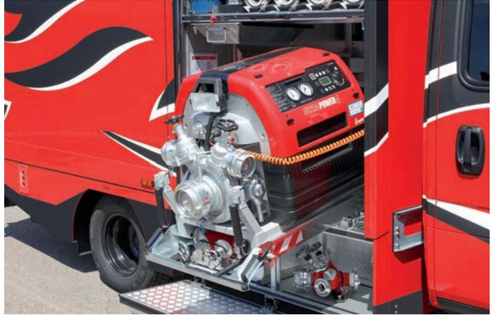
■ **Geräteentnahme:** Der Schwerlastauszug für die Tragkraftspritze ist absenkbar. Durch die Schrägstellung kann das Gerät schnell und ergonomisch schonend entnommen und solitär eingesetzt werden.
