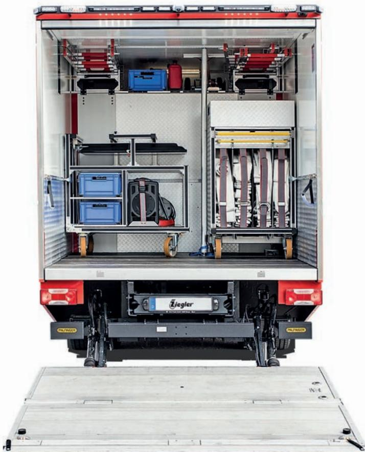
■ HALTE- UND SCHIEBEEINRICHTUNG MIT „TOTMANNBREMSE“
