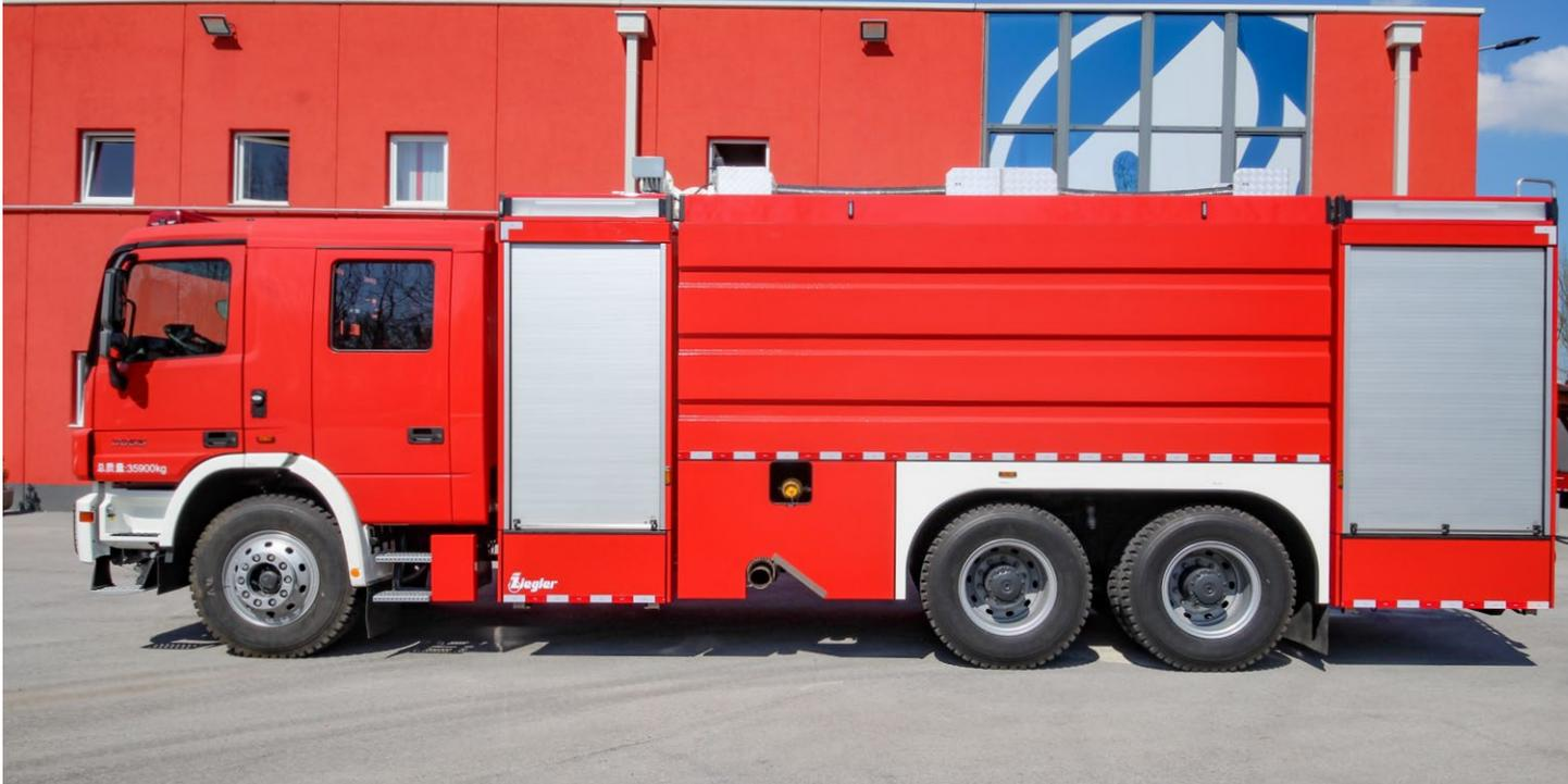
Ende April produzierte die ZIEGLER Gruppe 10 baugleiche Fahrzeuge des Typs TLF 80/180 für Guangzhou, China. Die Feuerwehrfahrzeuge, die auf einem Mercedes-Benz Fahrgestell aufgebaut sind, verfügen neben den ZIEGLER-spezifischen Komponenten wie Selbstschutzsystem und Schaumzumischgerät MAD 5 auch über einen Wasserwerfer ZW 100/50 EF. Außerdem wurde ein TLF 100/90-20+2.000P für Binzhou, China produziert.
